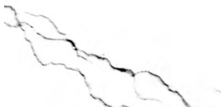
Рис.3. Продольные микротрещины на поверхности эмали
