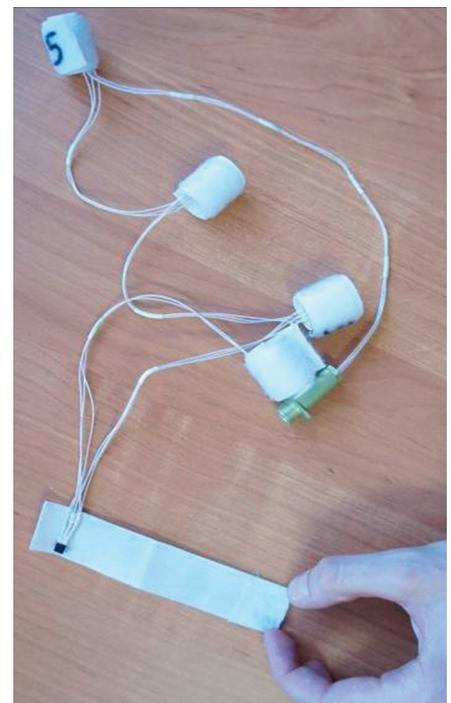
Рис.6. Расположение датчика в крепежном приспособлении
