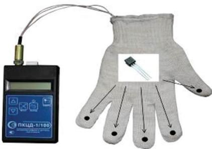
Рис.2. Макет термометрической перчатки
