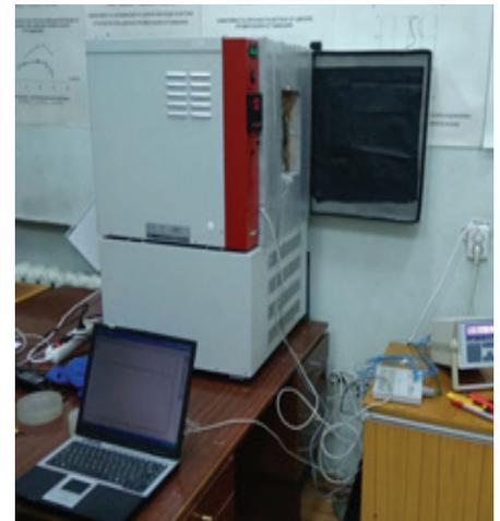
Рис. 1. Установка для измерения теплопроводности.
