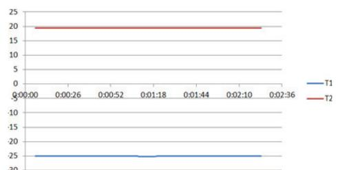
Рис. 4. Изменения температуры теплой и холодной сторон образца по времени
